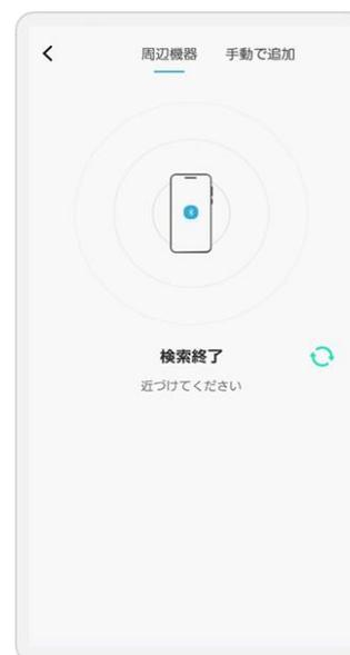
「<」をタップした後の画面では、製品アイコンをタップすることでスマートフォンと接続が開始され、計測データ画面に切り替わります。
