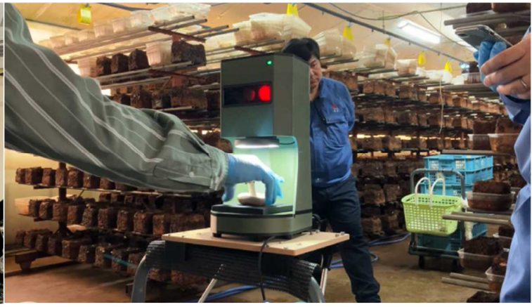
<AI 選果機(プロトタイプ)を用いた荒選別作業>
