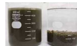
伯東独自の排水処理用薬剤「ハクトロン」は汚染水の一次処理に使用することで、蒸留装置の運用効率が向上(写真左から処理前、処理後)
