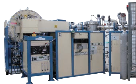
ナショナル エレクトロスタティクス 炭素14年代測定装置(ペレット加速装置)
